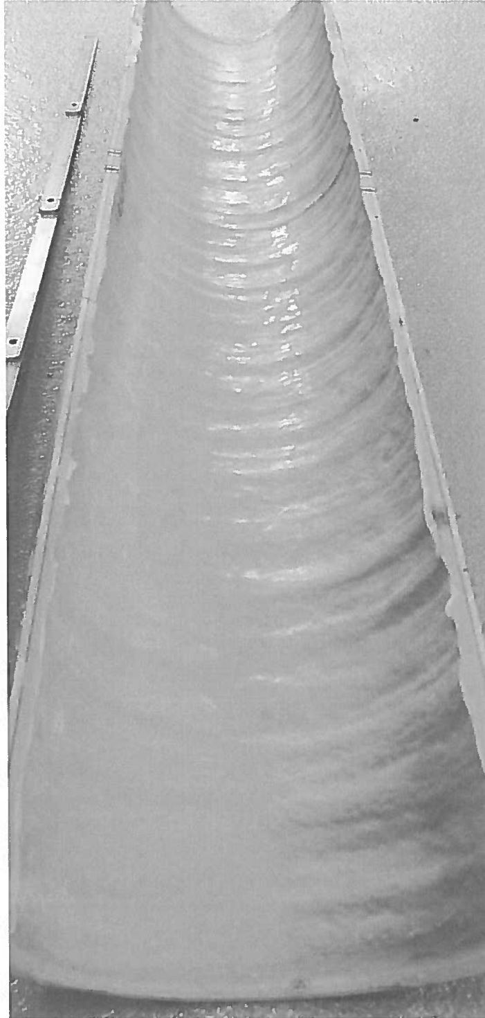
Abbildung 5: innere Oberfläche des untersuchten „Proline Harzsystem“ nach Abschluss der 100.000 Lastspiele des Abrasionsversuchs
